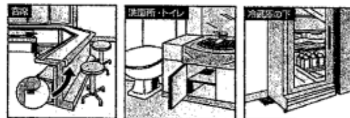
トラップ設置場所
